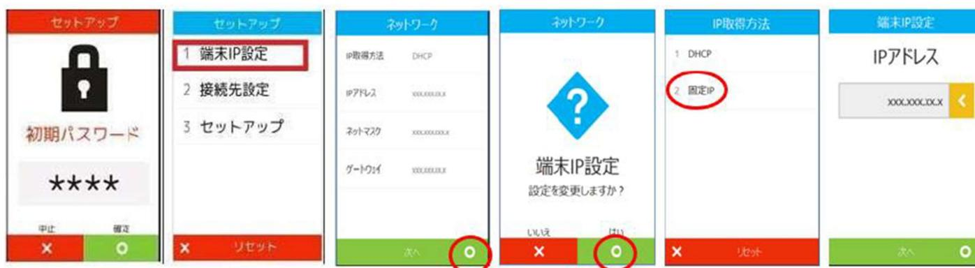
前頁、上右図の起動時の画面に寺岡ロゴが表示された端末は、前述②③の順番でローカル IP を設定します（IP アドレス入力時の 0 は省いて入力します。例 192.168.1.11）
